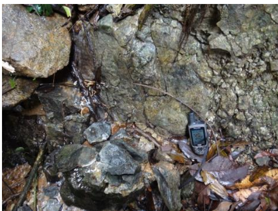
相片 5. 微閃長岩侵入斑岩露出地表的部分，隨礦化網狀石英脈的高溫蝕變。
