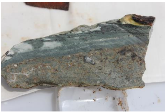
相片 25. 砂岩 - 粉砂岩浮石中的浸染狀黃銅礦和主靜脈斑銅礦礦化。
