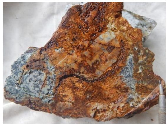
相片 22. 二氧化矽 - 絹雲母 - 粘土蝕變砂岩浮石具有豐富的藍黑二次銅氧化物礦化。
