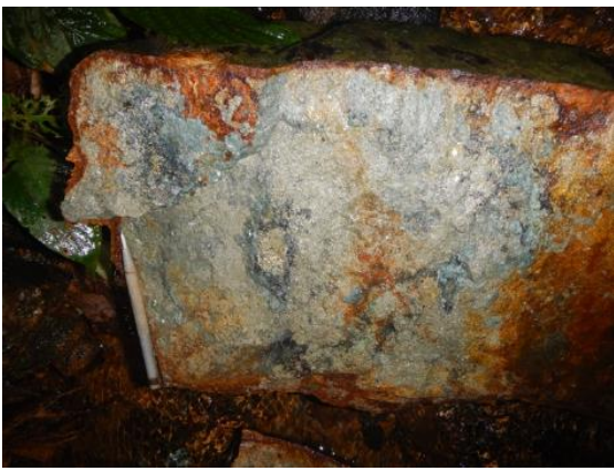
相片 21. 於二氧化矽 - 綠簾石 - 綠泥石 - 絹雲母逆行矽卡岩巨礫浮石的銅浸染，半塊狀黃鐵礦 - 黃銅礦礦化。
