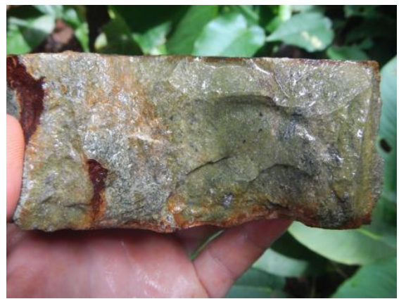
相片 24. 順行透輝石 - 石榴石 - 磁鐵礦矽卡岩與黃鐵礦 - 黃銅礦礦化。覆蓋黃銅礦的二次氧化銅(藍黑色礦物)小塊。
