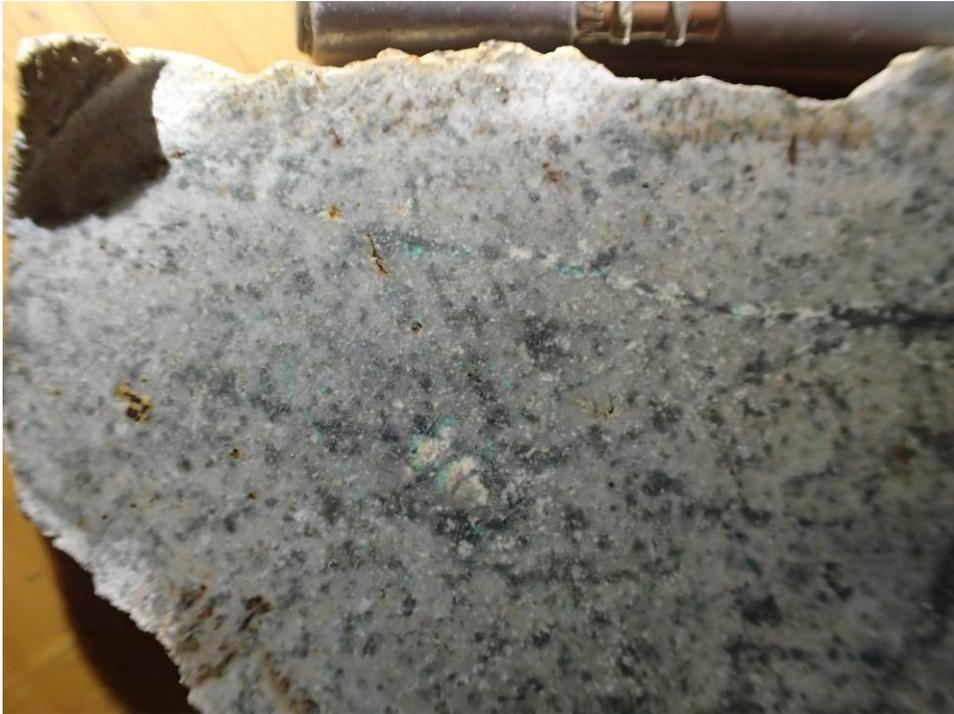
脈狀附存和浸染狀黃銅礦（在這張圖片中更好地顯現出切割後被氧化成綠色的孔雀石）。母岩蝕變為閃長岩。橫切脈狀是由石英 - 磁鐵礦 - 黃鐵礦 - 黃銅礦組成。這張圖片的寬度大約為 8 釐米。
