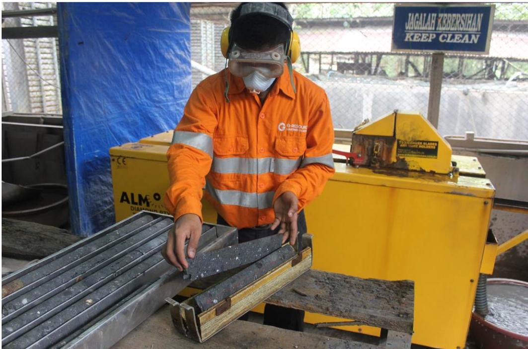
圖為核心棚技師 Komaruddin Hasibuan 先生用自動切割機採樣金剛石岩芯。該機器於「Martabe 改善計劃」項目下購買，並改進操作人員的安全，加快切割速度，完善採樣的工作流程，較傳統的切割工具降低耗材的使用。
