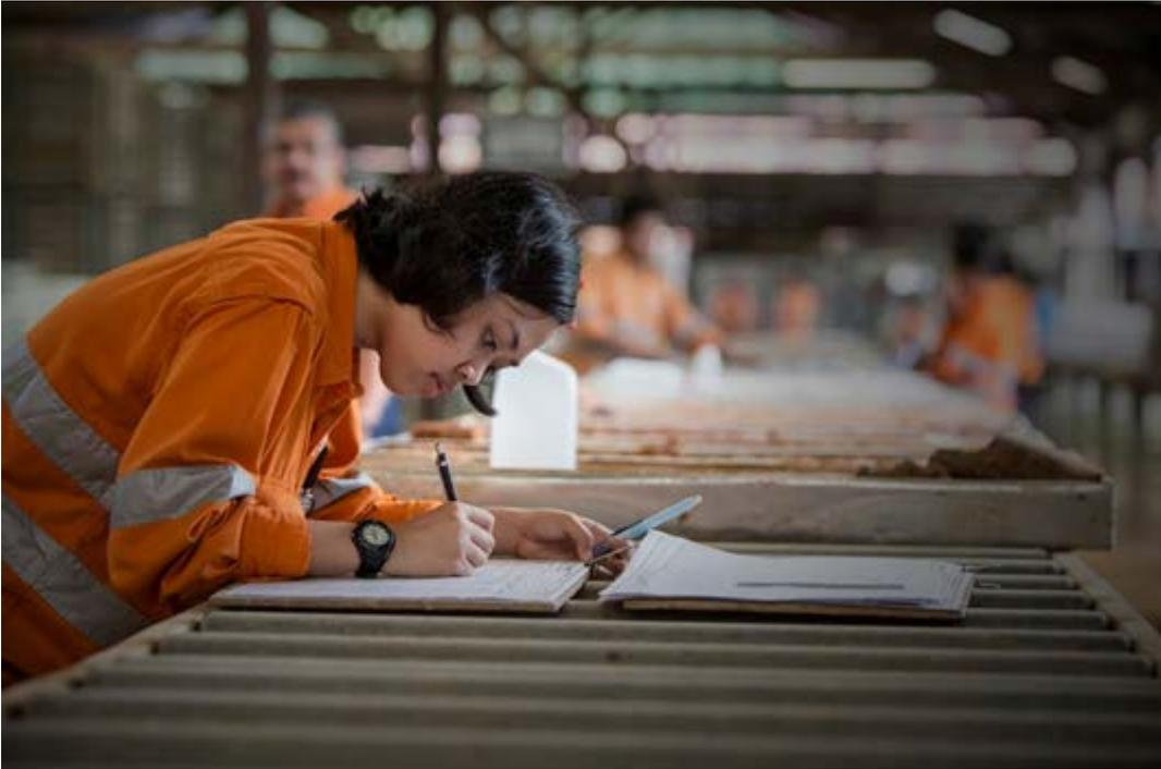
地質學家 **Aya Asaga** 女士於勘探核心棚編錄鑽孔岩芯。所有鑽孔岩芯的編錄均用於地質和技術用途，拍攝，並用金剛石鋸片切成一半或四分之一的岩石。一半岩芯被儲存，用於地質和採礦的進一步研究。自 **Martabe** 的第一個孔鑽以來，幾近所有的岩芯仍被存放在倉庫。
