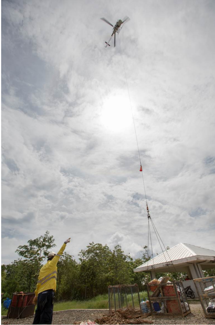
一位直升機裝卸隊長正從 Martabe 勘探基地向一個鑽探工地運送物資。
